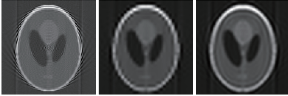
図 2. リングアーティファクトを含む CT 画像（左），離散 wavelet 変換によるノイズ除去結果（中央），提案法によるノイズ除去結果（右）
