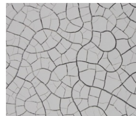
図 1. 収縮破壊パターンの例 (炭酸水酸化マグネシウム粉末と蒸留水の混合ペーストの乾燥亀裂)。
