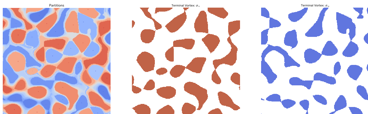
図 1: 乱流データにおける末端渦の例。左図は TFDA によって計算された COT 表現に基づくトポロジカルな領域分割構造を表す。中央図と右図はそれぞれ COT の末端ノードにおける \sigma_+ および \sigma_- に対応する渦領域を抽出したものである。
